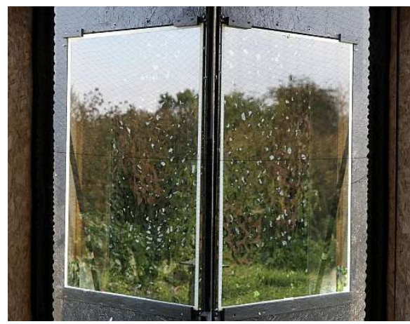
Abbildung 13: WIN-Referenztest birdpen vs. Floatglas. Links unmarkierte Floatglasscheibe (Referenz), rechts Prüfscheibe ( birdpen auf Floatglas).
