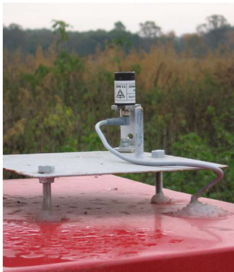
Abbildung 5: Photovoltaik-Sensor zur Messung der Globalstrahlung.
