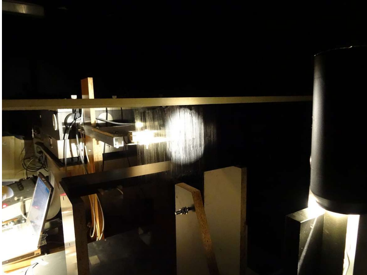
Abbildung 7: Spektrale Messung, hier der Transmissions-Eigenschaften, einer großflächigen birdpen -Beschichtung. Rechts: Lichtquelle, Bildmitte angestrahlte birdpen -Beschichtung. Der Sensor des Spektrometers befindet sich dahinter (links). Die Prüfscheibe wird mit Computer-gesteuerten Stellmotoren ausgerichtet.
