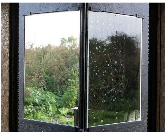
Abbildung 12: WIN-Versuch. Links Spiegel (Referenz), rechts Prüfscheibe ( birdpen auf Floatglas)
