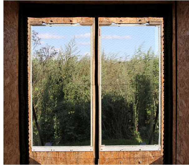
Abbildung 11: ONR-Versuch. Blick aus Perspektive der durch den Tunnel fliegenden Vögel auf Referenzscheibe (links) und Prüfscheibe (rechts).
